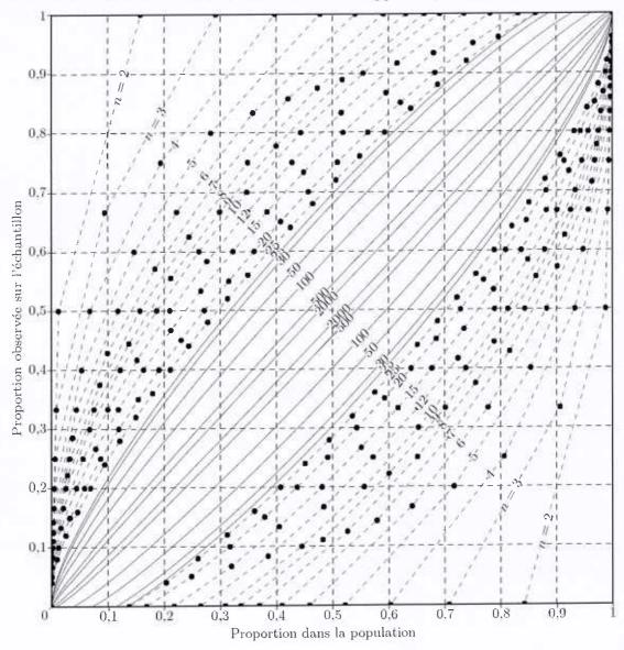
En ordonnée, on place la proportion observée p et on obtient les bornes inférieure et supérieure de l'intervalle de confiance approximatif comme les abscisses des points d'intersection de la droite horizontale y=p avec les deux courbes correspondant à la taille n de l'échantillon.
